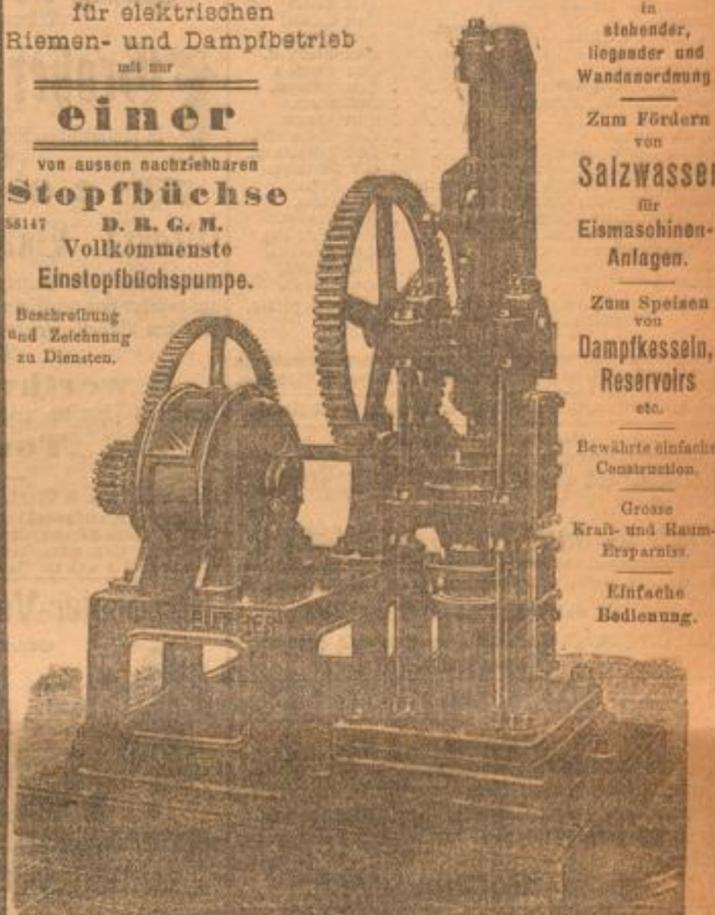
Doppeltwirkende Speise-Pumpe mit elektrischem Antrieb.
