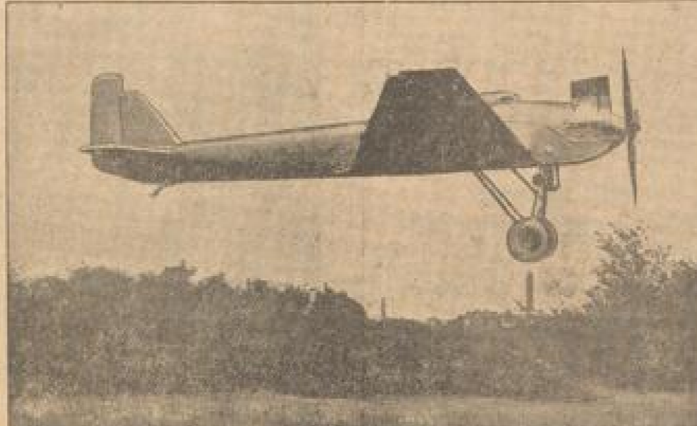
„Ju 49“ in der Luft In Dessau land in aller Stille der erste Stratosphären-Flugzeug „Ju 49“ auf. Das Flugzeug, das eine Spannweite von 26 Metern hat, ist mit einem Motor von 100 PS. ausgerüstet. Auffällig sind das hohe Fahrgerüst und die geringen Flügelstiele. Der erste Flug verlief sehr erfolgreich; mit den eigentlichen Höhenflügen wird man erst in einigen Monaten beginnen.
