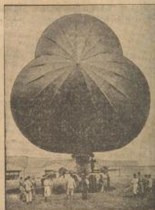
Der lenkbare „Zepplin“ während des Auftriebs. Ein eigenartiges Luftschiff ist in Frankreich gebaut und in den Dienst der Kriegsmarine gestellt worden. Das Luftschiff, das sich ausstreckt mit einer Netzhaut, wie ein großer Ballon, ist 120 Meter lang, 10 Meter hoch und vermag eine Beladung von 6 Mann zu tragen.
