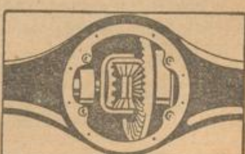
Banjo-Achse mit Differential. Geräuschlose Spezialverzahnung.
