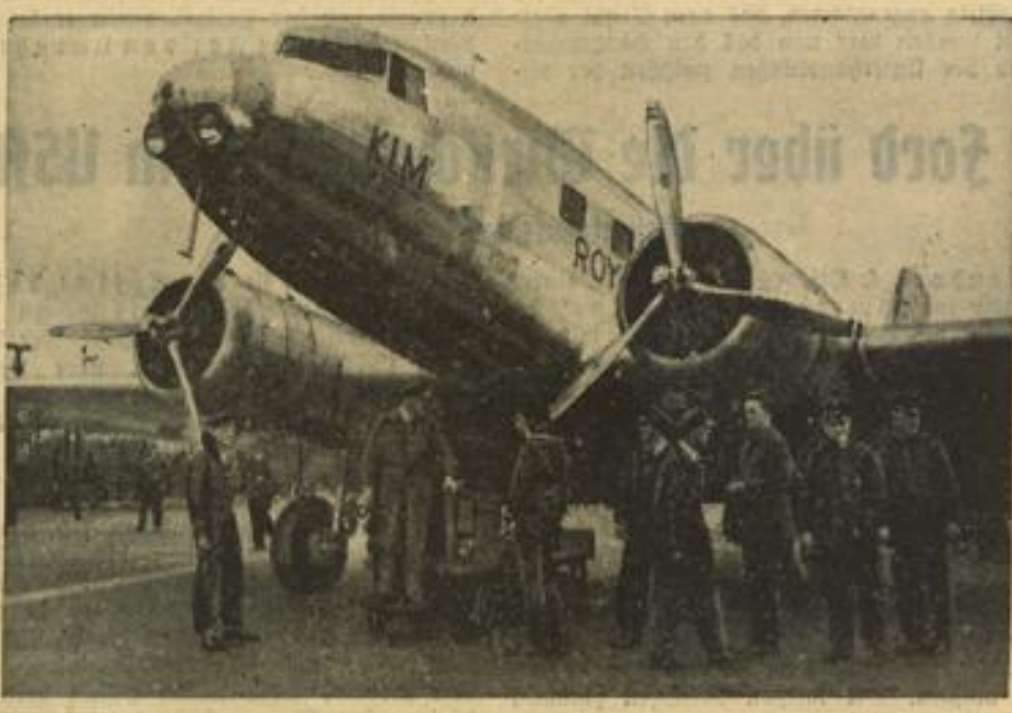
Die Holländische Luftfahrt-Gesellschaft (K. L. M.) hat auf der Strecke Berlin—Rotterdam erstmalig ein neues zweimotoriges Ganzmetallflugzeug amerikanischer Bauart in den Verkehr gestellt. Unser Bild zeigt die neue Douglas DC-2-Maschine, die gänzlich aus Duraluminium gebaut ist und 14 Fluggästen Platz bietet, nach ihrer ersten Landung auf dem Flugplatz Tempelhof.
