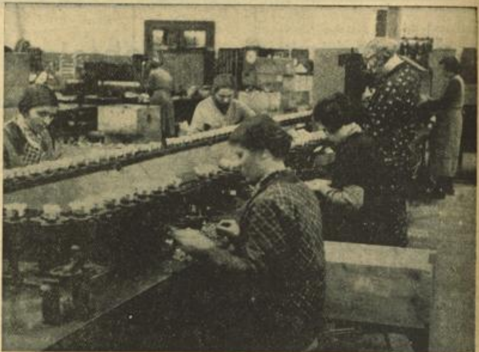
Montage von Sicherungselementen am laufenden Band
