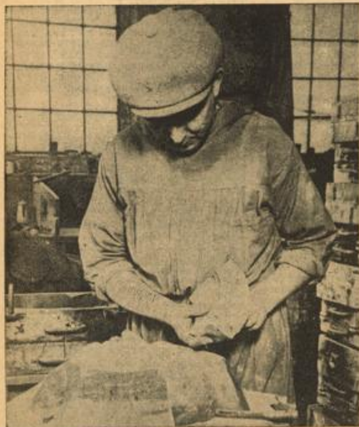
Vorne: So wird der „Kern“ für den späteren Abguß hergestellt
