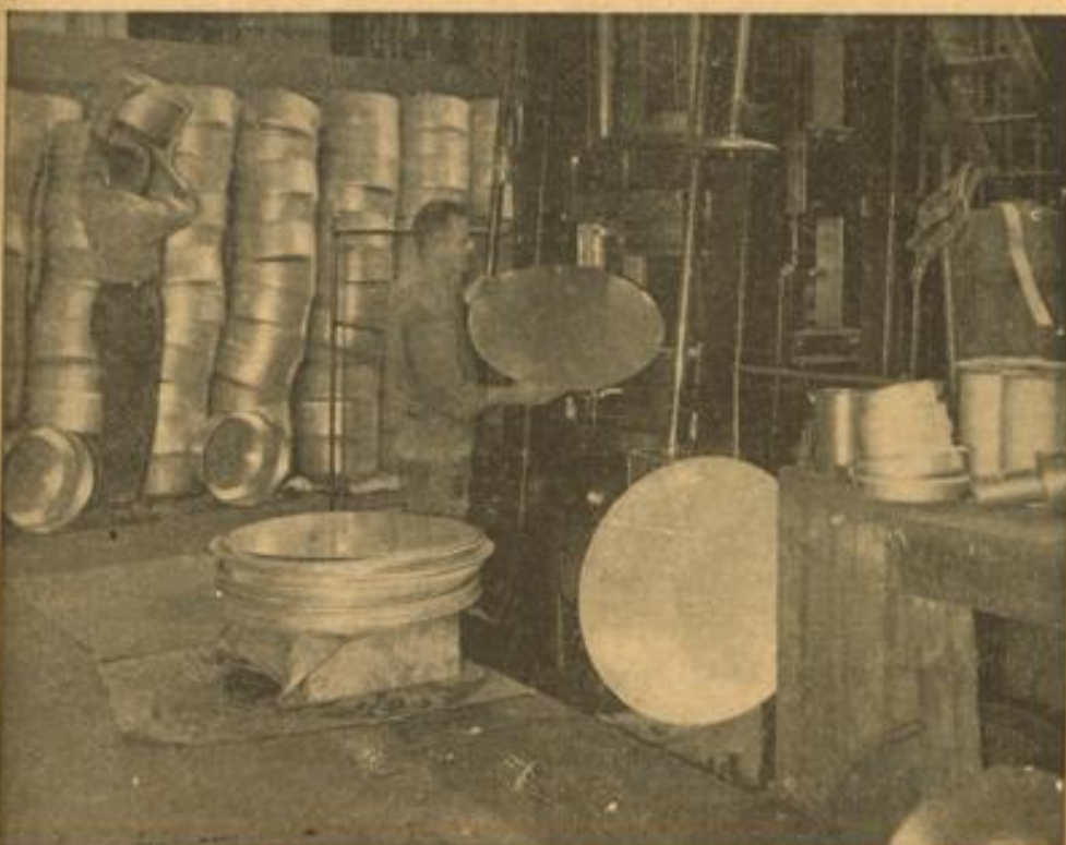
Aus Aluminium-Ronden werden auf der Presse Fleischtlöpfe gezogen
