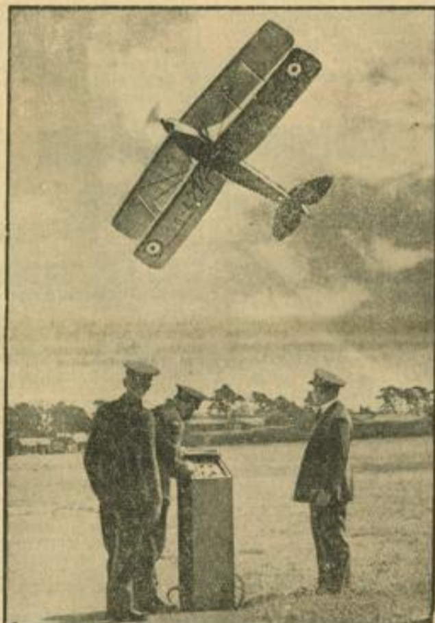
In England finden gegenwärtig bei der Marine und den Küstenbatterien Flugzeugabwehrübungen mit ferngesteuerten Flugzeugen statt, die bis zu 3000 Meter Höhe erreichen und sich 16 Kilometer von der Kontrollstation entfernen können.
