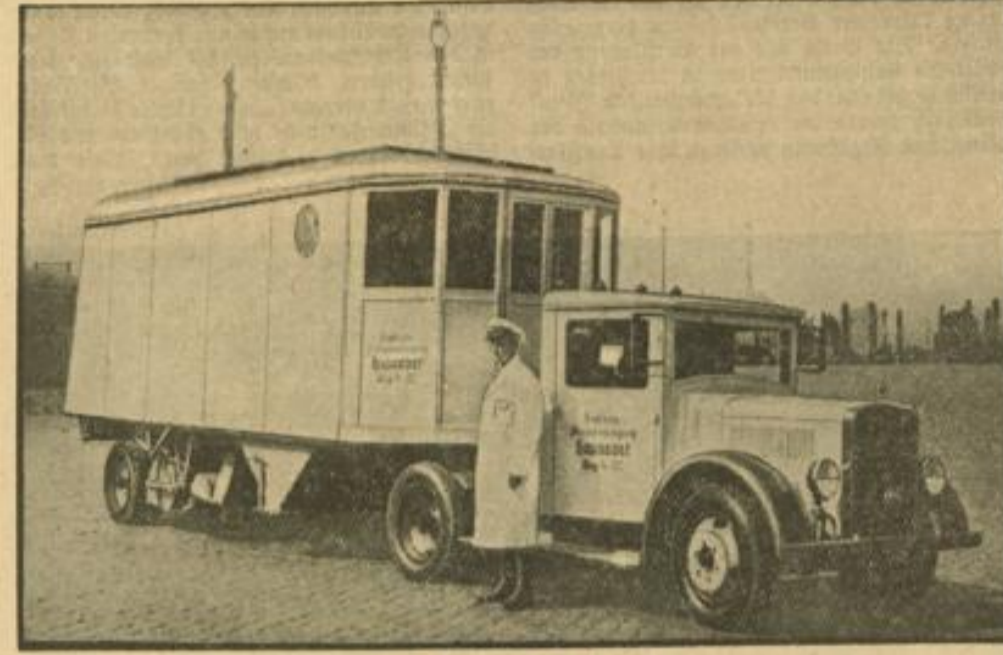
Die neueste Rebmachine der Städtischen Straßenreinigung in Hannover. Die Maschine, die 1000 Kilogramm feinen Staub und 3000 Kilogramm Straßenschmutz in sechs Arbeitsstunden aufnehmen kann, arbeitet ähnlich wie der allgemein bekannte Staubsauger.
