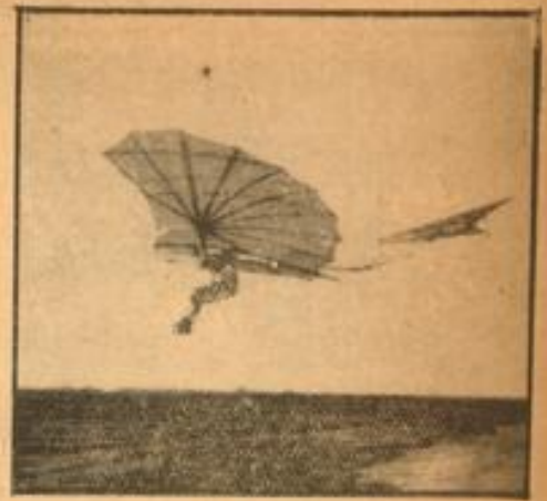
Otto Lilienthal, der deutsche Vater des Flugwesens, hat sich eingehend mit dem Problem des Vogelstuges beschäftigt und mehrfach Apparate konstruiert, die bewegliche Schwingen beluden. Unter Bild zeigt ihn bei einem Flug von seinem künstlichen Flügel in Berlin-Vieritzsee.
