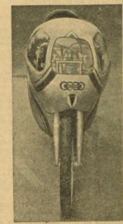
Motorräder auf Rekordjagd Die Stirnseite des neuen halbholbenen Stromlinienmodells der 250er-DKW (links). Auf der Reichsautobahn bei Frankfurt a. M. nahmen auch die Motorräder im Rahmen der Rekordwoche der ONS ihre Fahrten auf...
