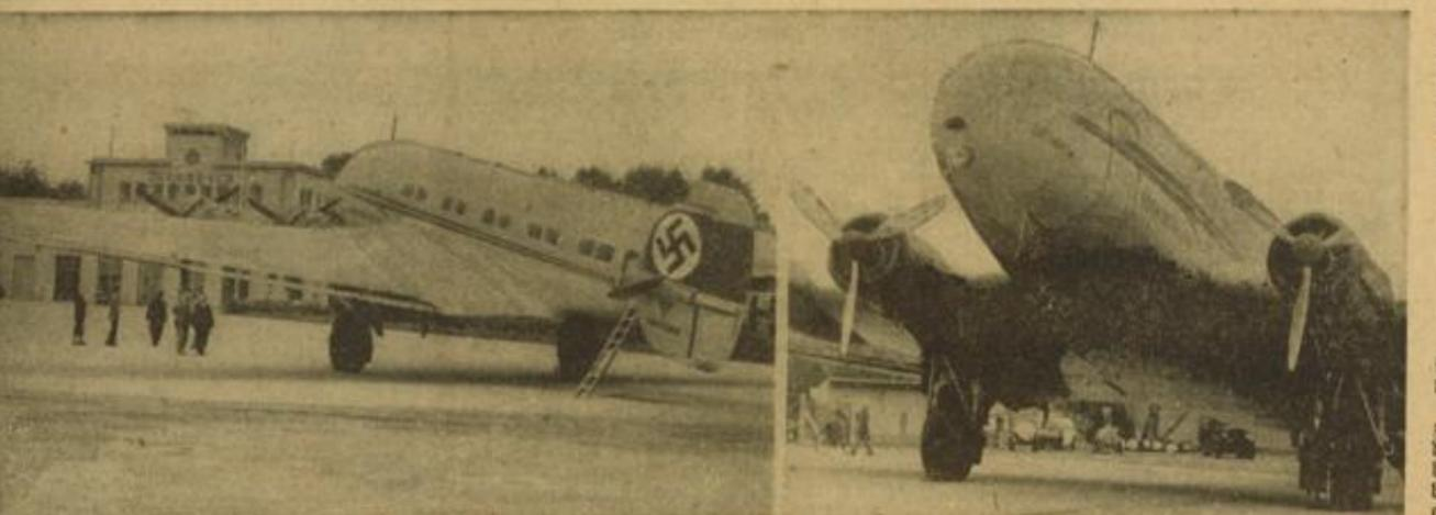
Auf dem rechten Bild erkennt man, wie gedrungen die ganze Maschine ist, während auf dem linken Bild die Ausmaße zu erkennen sind. Hat doch allein ein Rad des Fahrgestells — das ebenso wieder rückwärtige Dorn des Flugzeuges während des Fluges eingezogen wird — die Höhe eines erwachsenen Menschen. Aufn. (2): Hans Jütte
