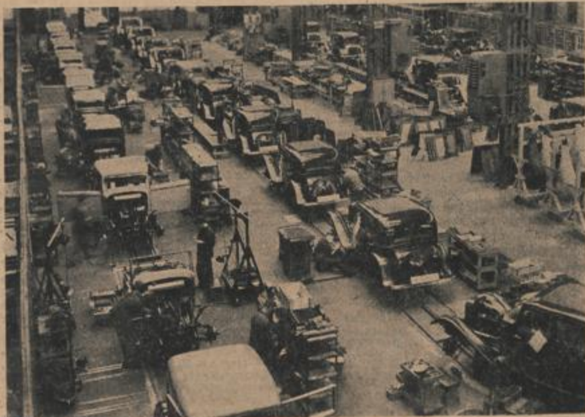
Alle 10 Minuten verläßt ein fertiger Wagen das laufende Band. Blick in die weite Montagehalle des Werkes.
