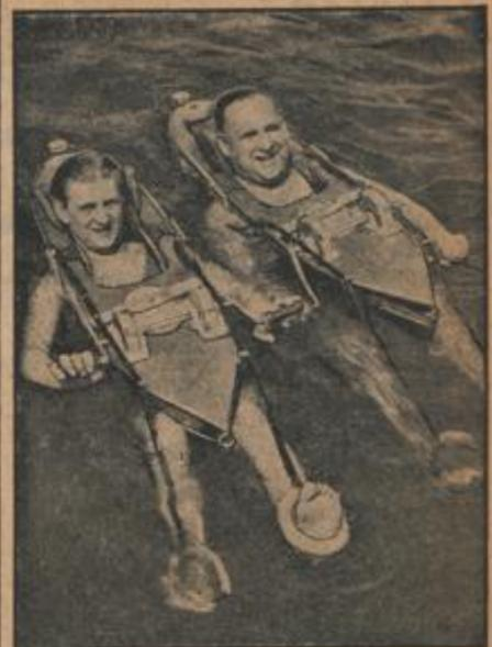
Eine Erfindung für Nichtschwimmer und Taule. Diese Apparatur erlaubt auch Nichtschwimmern, sich wie ein Fisch durchs Wasser zu bewegen. Der Antrieb erfolgt durch die mit den Händen zu betätigenden Pedale. Bewegert wird mit den Füßen, die in den Endringen der Steuermechanik ruhen. Der Kopf des Tauchers, der sich in seiner Richtung vorwärtsbewegt, liegt auf einem schwebenden Halter. Alles in allem: eine ideale Einrichtung für schwache Leute.
