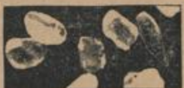
Grobes Scheuermittel feucht, 40 mal vergr. Die spitzigen und groben Mineralsplücker verursachen Kratzer.
