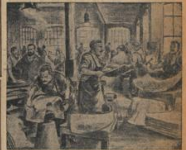
Im Jahre 1907 10 Wagen Tageserzeugung, also 40 Kottflügel. Die Bleche werden handgehämmert. Jedes Stück braucht acht Stunden Arbeitszeit. Sämtliche Bilder aus: Heinrich Dauter, „Opel, ein deutsches Tor zur Welt“. Zeichnungen: Hans Wenzl.
