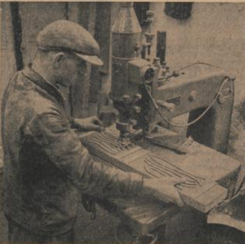
Das Rechte für den Großbetrieb: Oberseite mit 24.000 Umdrehungen je Minute. Ueber 200 anmündelbare Messer leisten hier wähte Feinbearbeitung der Korzerte für Profile, Auslagen und die verschiedenartigen „runden Böden“.
