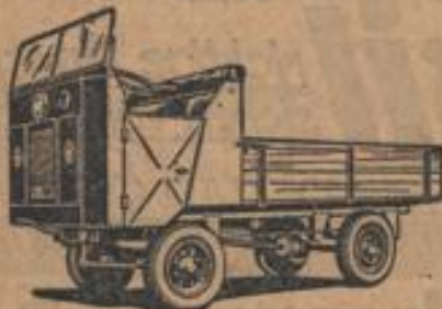
10 PS Hanomag-Klein-Lastwagen mit Pritsche und abklappbaren Seitenteilen
