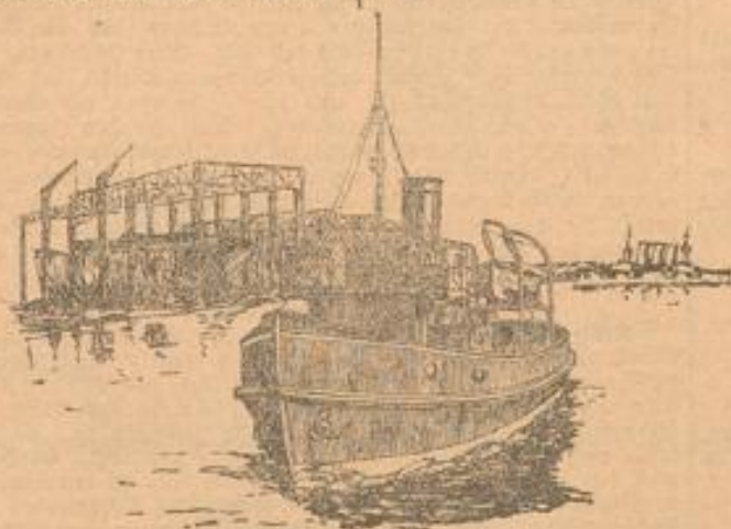
Motorschlepper mit 530 PS. Schiffdieselmachine Benz-Hesselmann.
