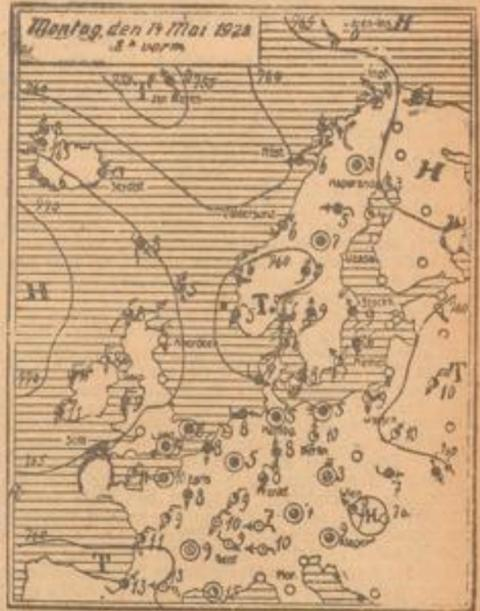
Die Werte zeigen mit dem Winde. Die bei den Stationen fehlenden Zahlen geben die Temperatur an. Die Linien verbinden Orte mit gleichem auf 1000m über dem Meeresspiegel gemessenen Luftdruck.
