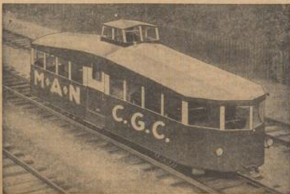
Der neue Diesel-Schienenomnibus der Maschinenfabrik Augsburg-Kürnberg auf einer seiner Probefahrten
