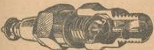
Abbildung 2: Zündkerze mit vor den Elektroden angebrachtem „Ringelektroden“ als Schutz gegen Verschleiß und Verschleiss.
