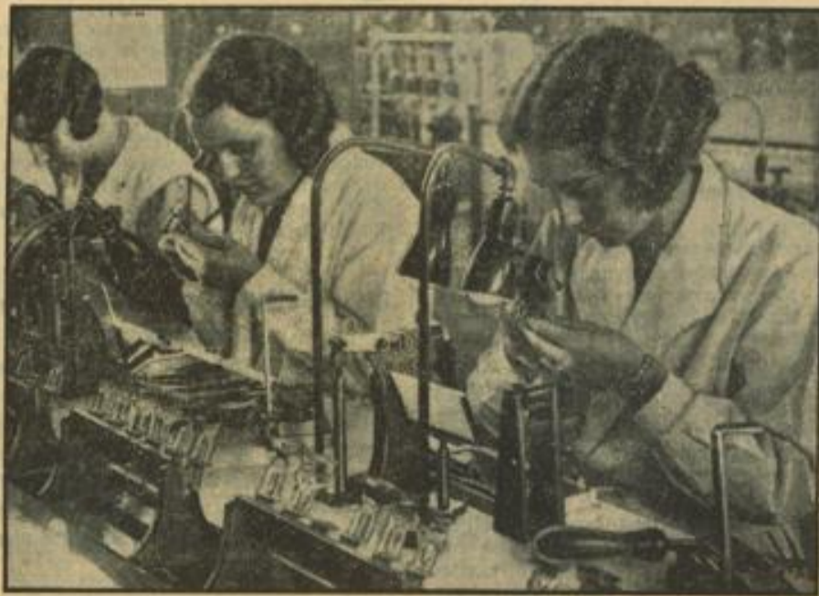
Ein Blick in die Halle der Arbeit, in der während der Dauer der Großen Deutschen Funkausstellung 1934 den Besuchern die Herstellung des Volksempfängers bis zum fertigen Gerät vorgeführt wird. Unser Bild zeigt einen Ausschnitt aus dem Arbeitsgang: Röhrenherstellung
