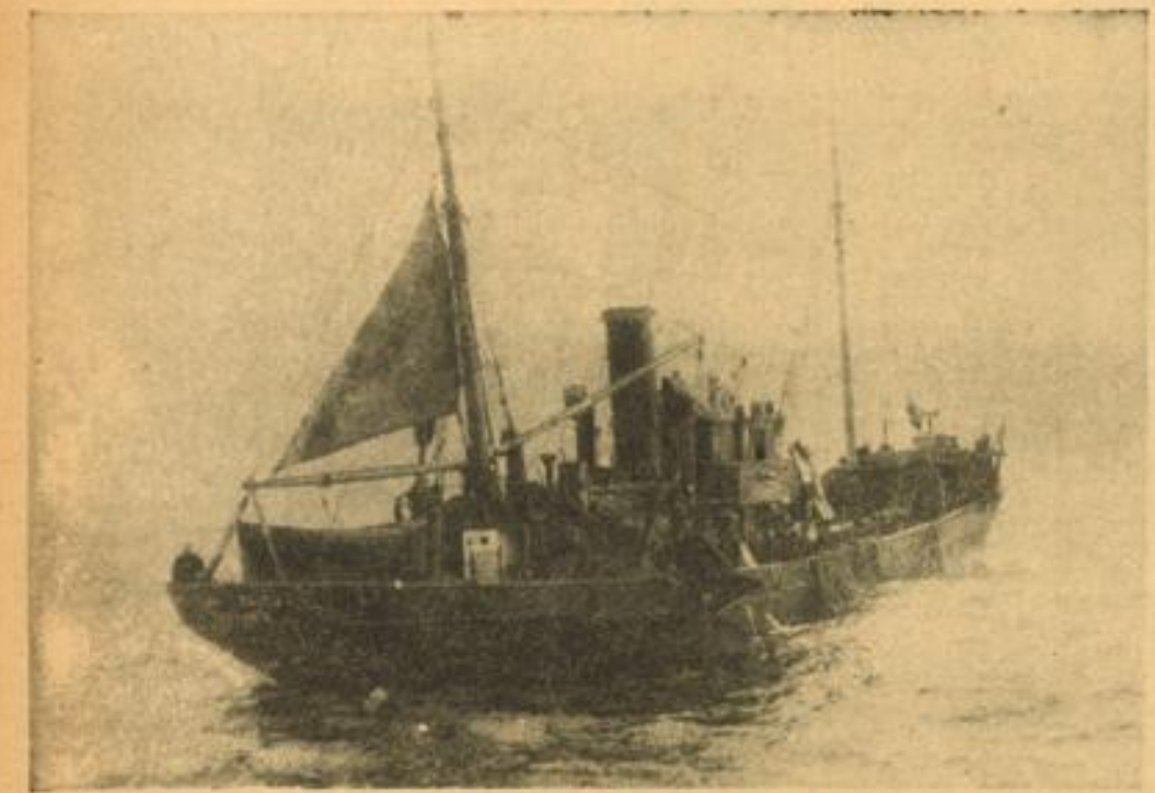
So sieht ein moderner Fischdampfer aus Deutscher Fischdampfer beim Auswerfen des Schleppnetzes
