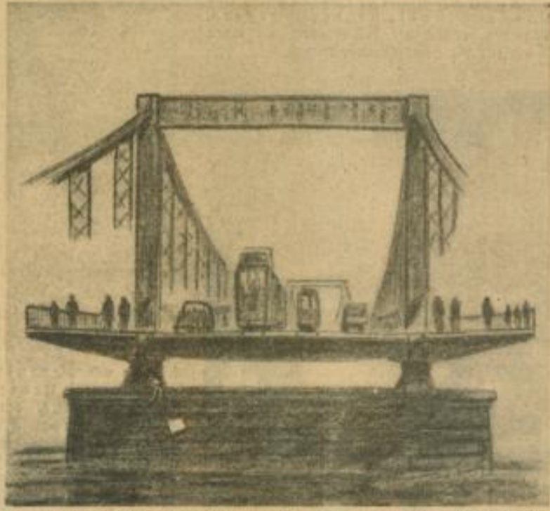
Oben: Querschnitt durch die auf 25 m verbreiterte Neckarbrücke, Verlegung der Straßenbahn in die Mitte, die Radfahrer außerhalb auf besonderem Radweg. — Links: Querschnitt durch die bisherige Brücke von 20 Meter Breite. Auf der Fahrbahn die Straßenbahn außen, dazwischen nur fünf Meter für Fahrzeuge.
