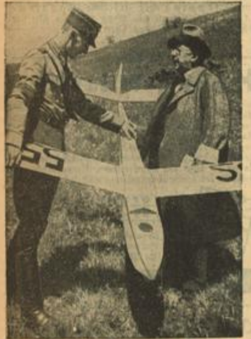
Segelflugmodell mit Fotozelle zur Selbststeuerung
