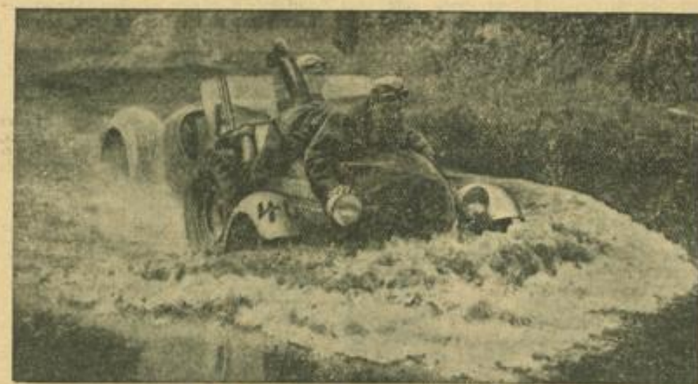
Von der ersten H-Kraftsportmeisterschaft Eine Wasserdurchfahrt von 25 Meter Länge und 60 Zentimeter Tiefe auf der Prüftrasse bei Hamburg macht den Bewerbern schwer zu schaffen. Hier ist der Mitfahrer aus dem Wagen geklettert, um durch Gewichtsverlagerung das Durchkommen zu erleichtern. Weltbild (M)
