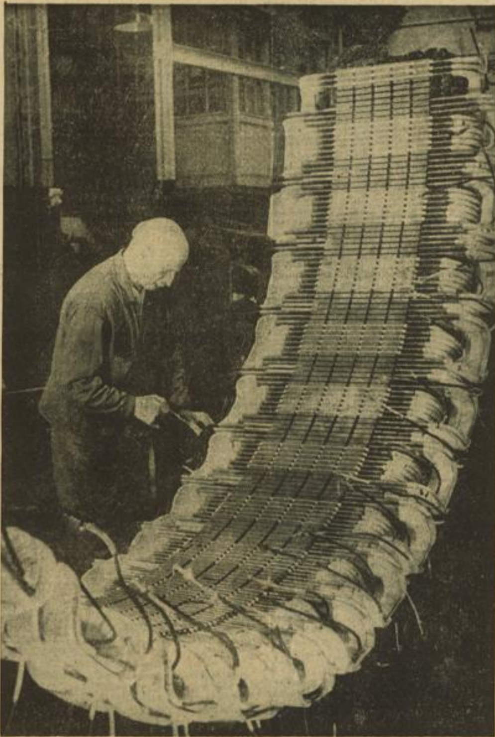
Zu den guten Facharbeitern der Ostmark gehören auch die Handwerker der Wiener Elektroindustrie. Das Bild aus der Wiener Elektroindustrie zeigt einen solchen Facharbeiter bei der Wickelarbeit am Stator eines großen Drehstrommotors. Werkf.: Siemens-Pressbildzentrale
